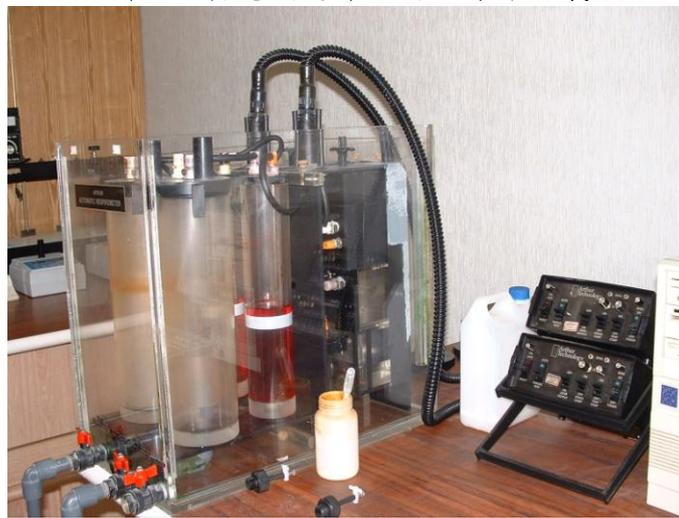
圖 3 呼吸儀反應測試槽(左)和控制系統(右)
