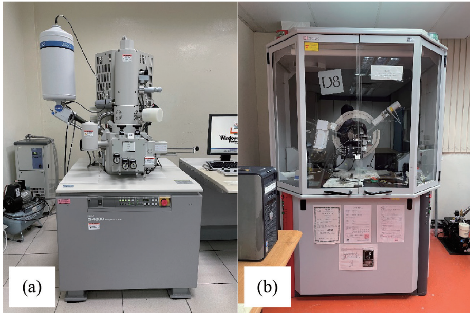
圖 7 (a) 掃描式電子顯微鏡 HITACHI S-4800；(b)X 繞射分析儀 Bruker D8
