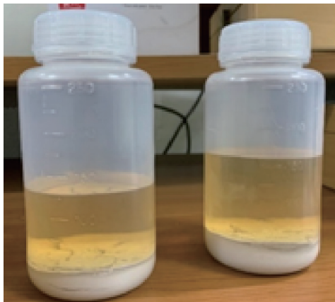
圖 19 白色沉澱氫氧化鋁膠羽需水洗離心取白色固體部分
