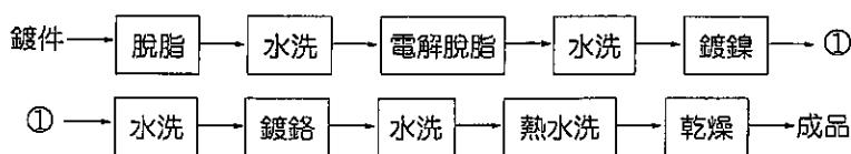
圖3.1 工業電鍍典型製程
