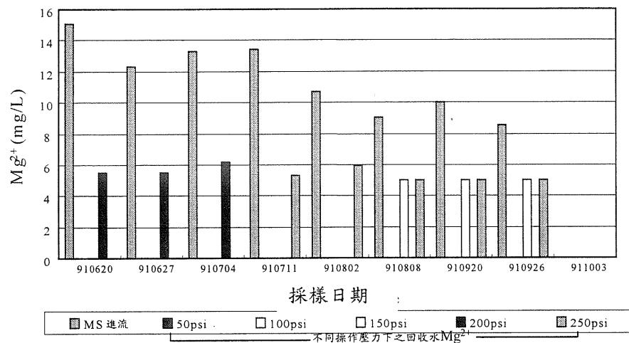
圖 12 不定期採樣下 MS 進流水及回收水在不同操作壓力下  $Mg^{2+}$  變化
