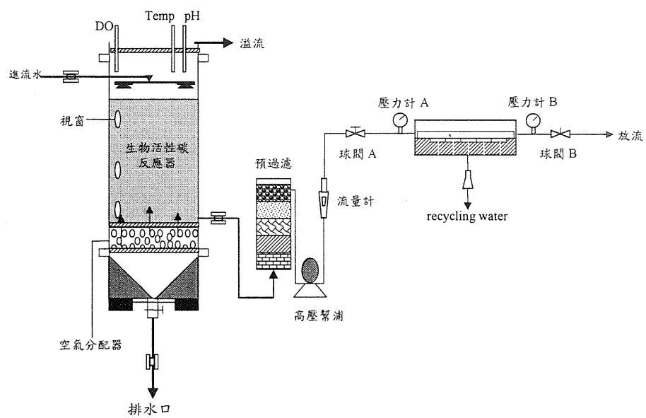
圖 2 BAC/MS 複合系統示意圖
