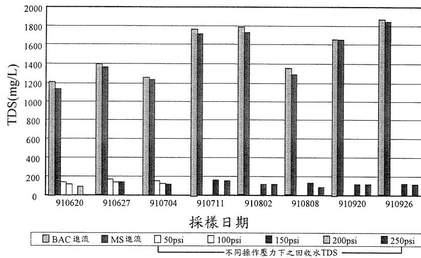
圖 9 不定期採樣下 BAC 進流水、MS 進流水及回收水在不同操作壓力下 TDS 變化
