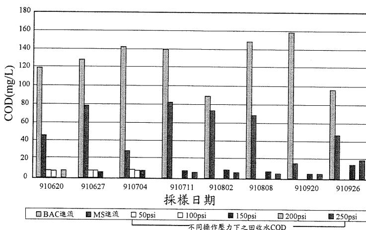
圖 8 不定期採樣下 BAC 進流水、MS 進流水及回收水在不同操作壓力下 COD 的變化
