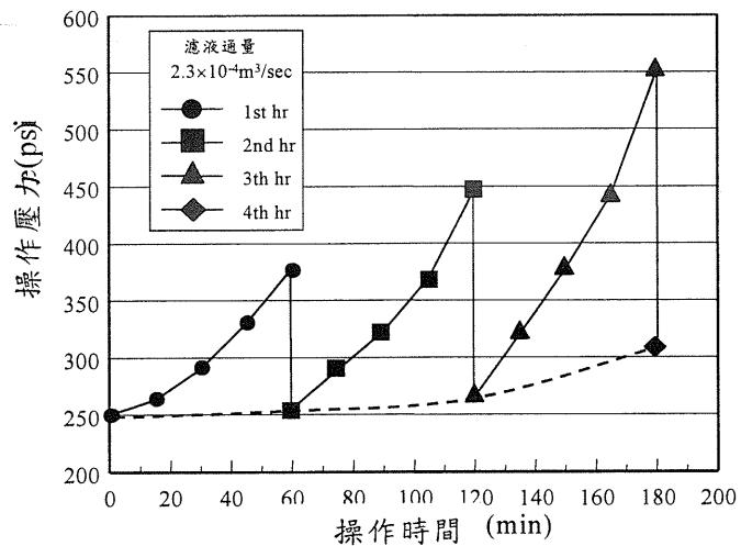
圖 16 濾液通量 14 L/min 操作壓力變化
