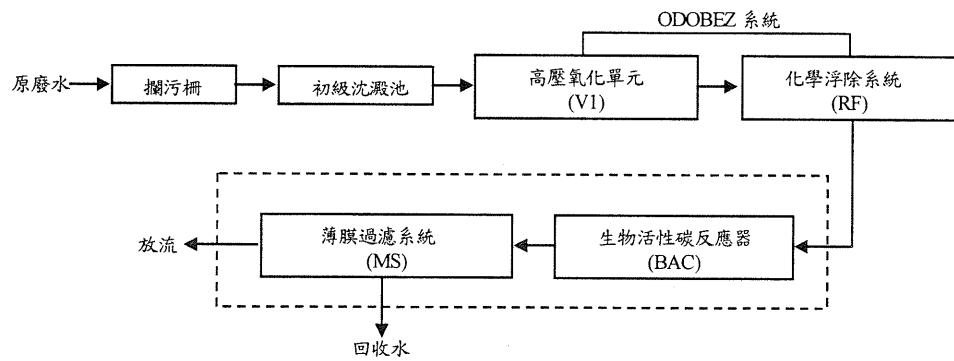
圖 1 現場廢水處理設備及本研究所採行廢水回收策略流程圖
