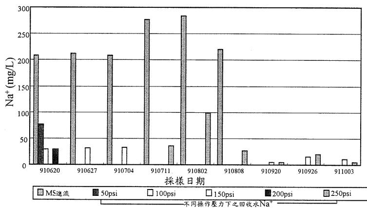
圖 11 不定期採樣下 MS 進流水及回收水在不同操作壓力下  $\text{Na}^+$  變化
