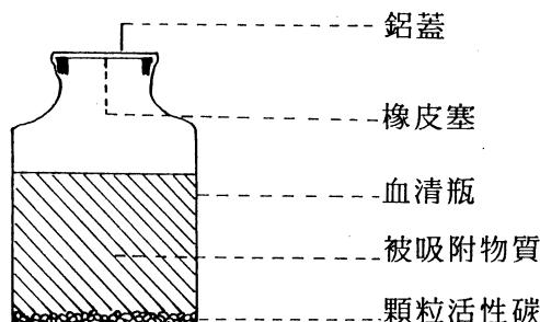
圖2.1 回分式恆溫吸附試驗裝置
