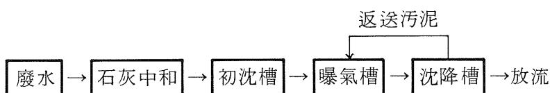
圖十九 有機磷廢水生物處理法流程
